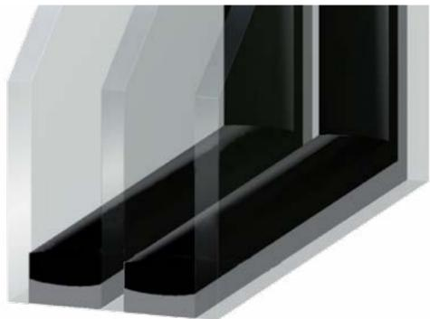
■  $U_g=0,6 \text{ W/m}^2\text{K}$  durch ökologisch sinnvolle Argon-Krypton-Mischung. K-Wert  $0,55 \text{ W/m}^2\text{K}$  bei 34mm Glasstärke. Dieser Glasaufbau und speziell die Argon-Krypton-Mischung wurden von uns so berechnet, dass die Gesamtenergiebilanz (Herstellung und Nutzung) möglichst günstig ausfällt.
